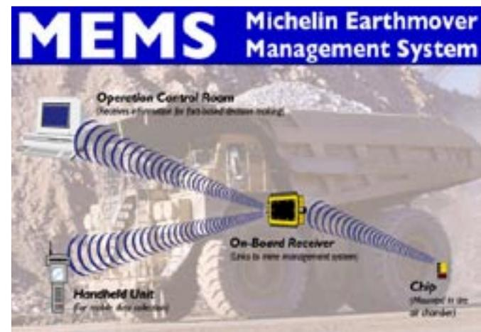
la alerta cuando hay un cambio en la presión o temperatura de los neumáticos en servicio. Esto permite hacer los ajustes para maximizar el funcionamiento y extender la vida útil del neumático, manteniendolos en funcionamiento dentro de los límites de diseño.
