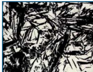
Figura 9. Microestructura de la Martensita
