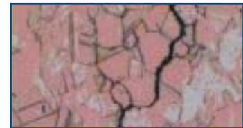
estas temperaturas se presentan en las proximidades de las zonas soldadas. Se forman carburos de cromo en los límites de los cristales de Austenita, empobreciendo la zona adyacente de este elemento (cromo) y quedando de esta forma expuesto a la corrosión. Una forma de evitar la corrosión intergranular es usar aceros de bajo contenido de carbono (tipo L), y cuando las condiciones de temperatura son aún más severas se debe usar aceros estabilizados.
