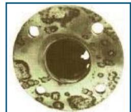
entre la grieta (microambiente) y la superficie externa da a la grieta un carácter anódico. Esto puede contribuir a una condición altamente corrosiva en la grieta. Algunos ejemplos de grietas se forman en rebordes, arandelas, juntas, empalmes rosca-dos y anillos. Algunos métodos para reducir los efectos de la corrosión de este tipo de corrosión son: eliminar la grieta en la etapa de diseño, seleccionar materiales más resistentes a este tipo de corrosión y reducir la agresividad del ambiente.
